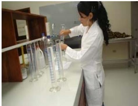
*Figura 2.10: Preparación de las muestras para determinar las concentraciones óptimas de sulfato de aluminio*
