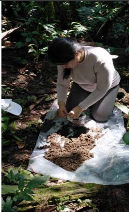
Recolección de muestras de suelo para la determinación de N, P, K
