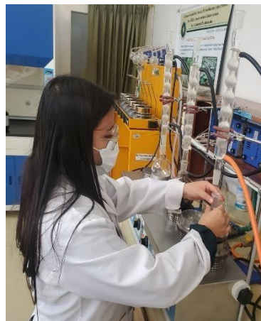
Figura 15: Acondicionamiento del equipo de reflujo.
