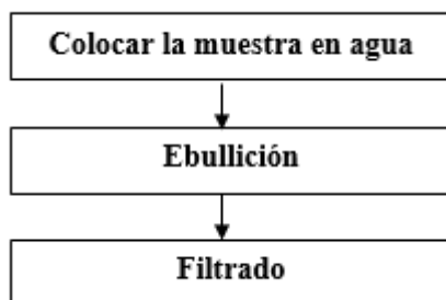
Figura 2: Etapas del proceso de decocción
