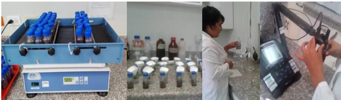
Foto A2.4. Preparación de muestras y análisis de Al^{3+} , acidez intercambiable y pH.
