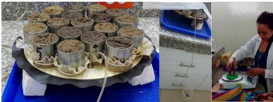
Foto A2.3. Evaluación de la distribución de tamaño de poros en los suelos.
