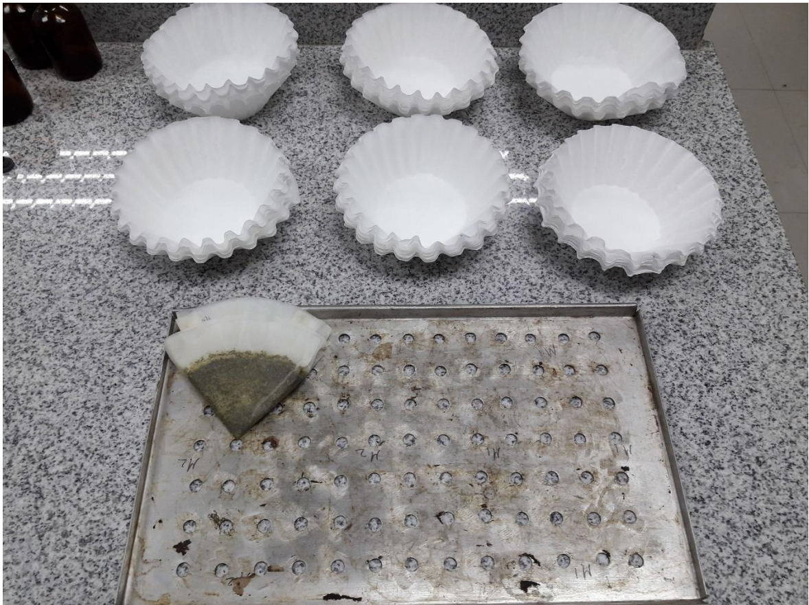
Anexo 12. Filtrado de muestras para determinar digestibilidad in vitro de la materia seca
