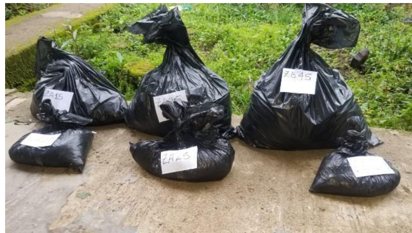
Figura 23. Identificación de las muestras de suelo y pastos para envío al laboratorio.
