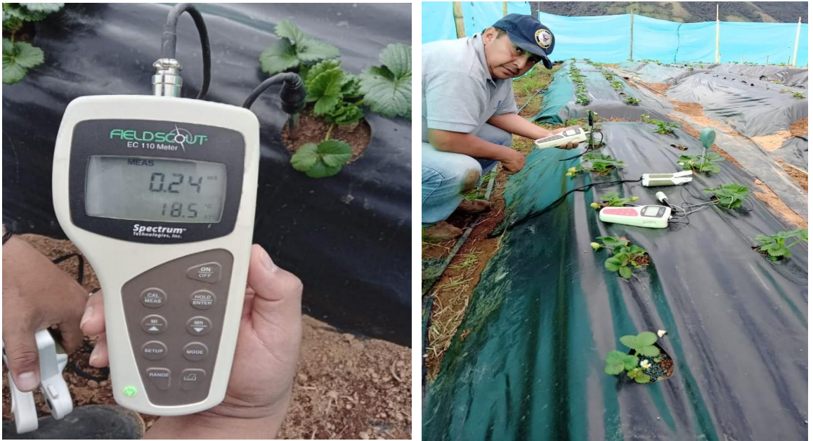
Figura 68 Medición de conductividad eléctrica del suelo
