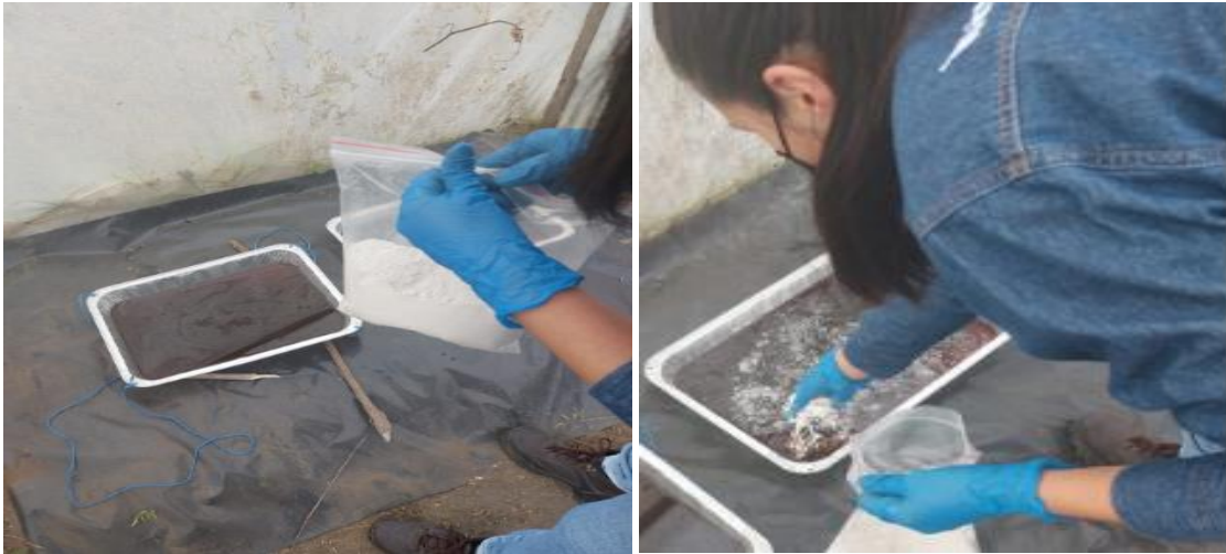
Anexo 4.- Lixiviado tratado con Cal y registro de datos de evaporacion diaria.
