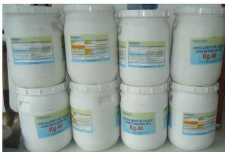
Figura 17. Producto utilizado para la desinfección en la Planta Potabilizadora del cantón Palora.
