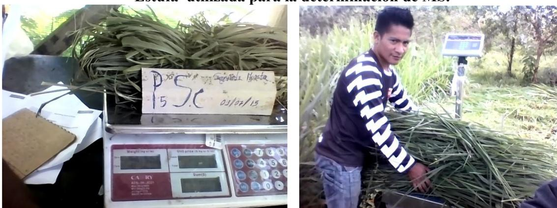
**Balanza digital utilizada para pesar la materia MV y MS**
