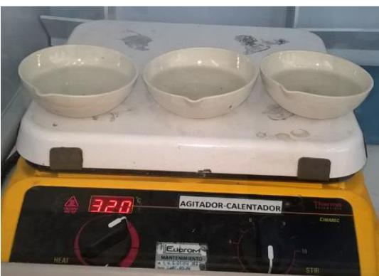
**Fotografía 31.** Muestras secas a una temperatura de 103-105 °C, por un periodo de 1-3 horas,
