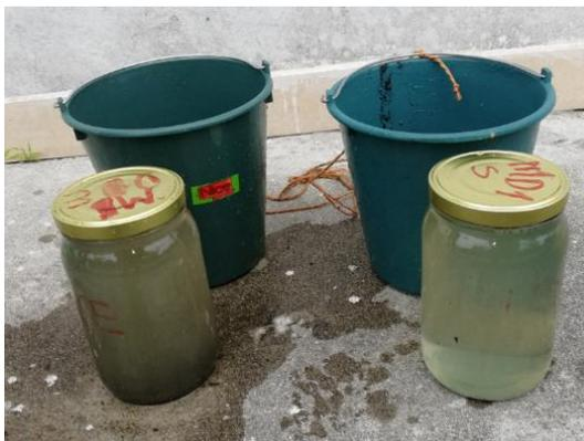
**Homogenización, caracterización parámetros físicos, diferenciación de alícuotas por volumen, etiquetado y envío de las muestras.**
