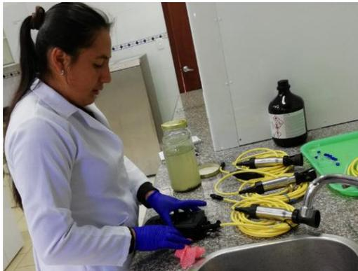
**Fotografía 23.** Limpieza de las sondas para la medición de los parámetros físicos.
