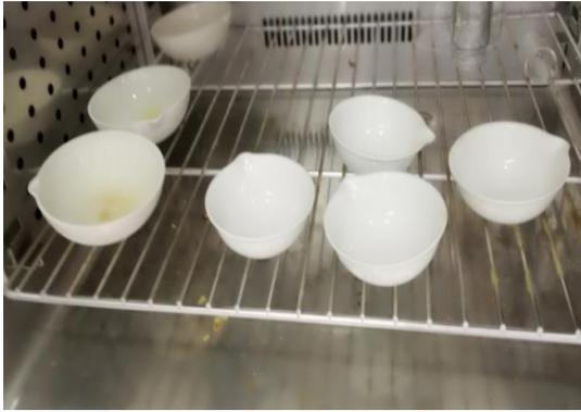
**Fotografía 33.** Cápsulas enfriándose en el desecador.
