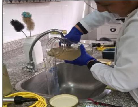
**Fotografía 17.** Vertido del volumen necesario para la homogenización de la muestra.
