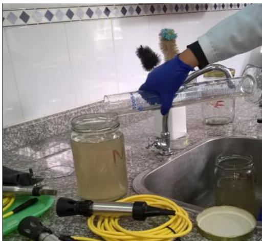
**Fotografía 18.** Muestra homogenizadas, etiquetadas y preparadas para el envío.
