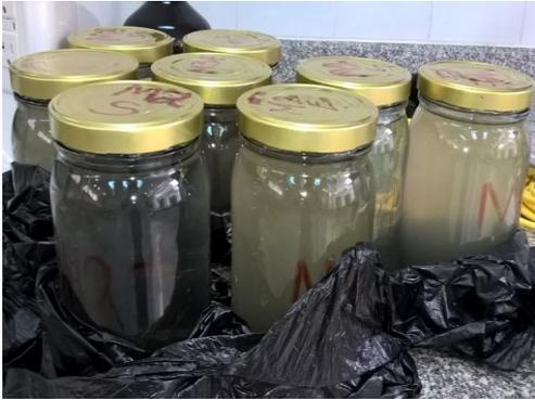
**Fotografía 16.** Homogenización de las muestras puntuales y toma del volumen requerido.
