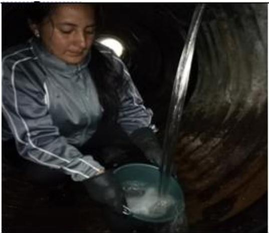
**Fotografía 12.** Muestras puntuales del afluente y efluente de la PTAR.
