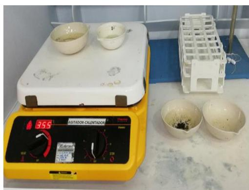
**Fotografía 32.** Cápsulas secas y ubicarlas en la estufa por 15min.
