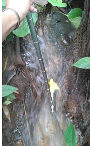
Fotografía 12 Medición de la velocidad del río Tunanza
