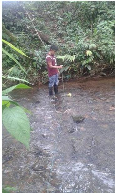
Fotografía 11 Medición de la velocidad del efluente de la PTAR
