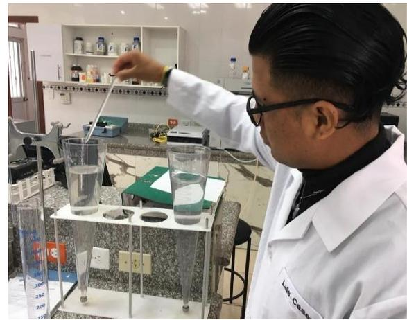
**Anexo 26.** Procedimiento para la determinación de sólidos sedimentable.
