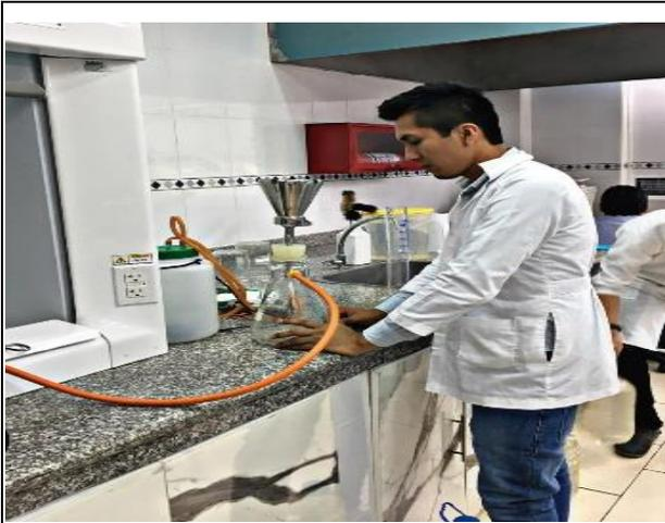
**Anexo 25.** Filtración de 100 ml de muestra para el análisis de sólidos disueltos totales.
