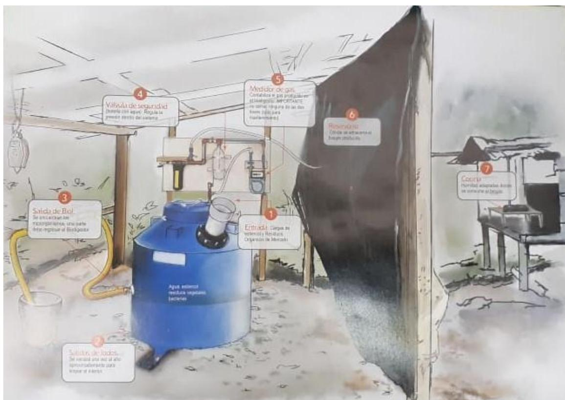
Figura 1. Biodigestor modelo chino. Fuente: Ribera, (2011)
