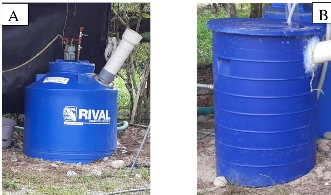
Figura 4. Biodigestores A (Biodigestor Moderno) y B (Biodigestor Tradicional).
