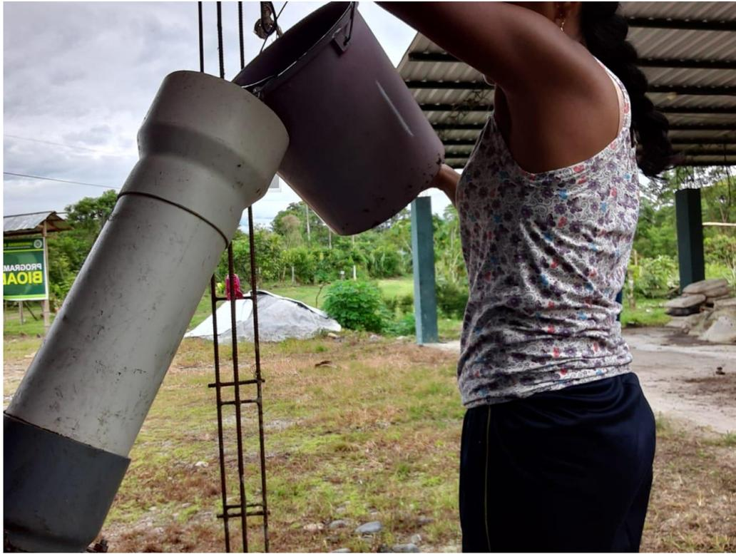
Figura 7. Carga de agua al biodigestor moderno.
