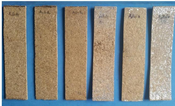
**Anexo 11. Ensayo de resistencia a la tensión 70% aserrín, 30% bagazo y blancola**
