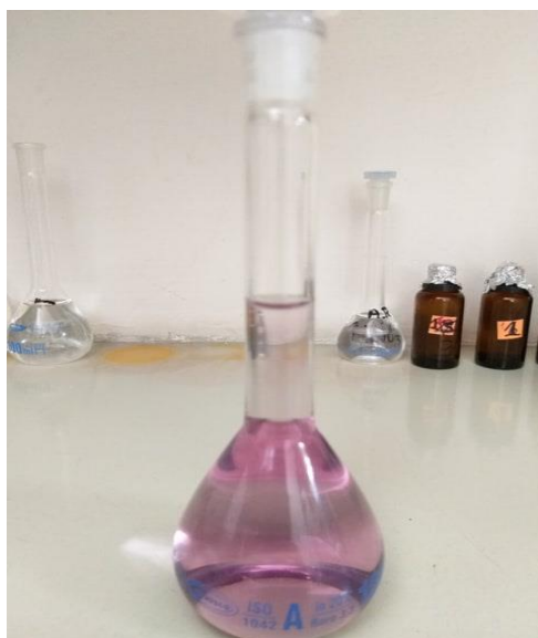
Figura 6. Disolución del ácido salicílico en presencia de cloruro férrico
