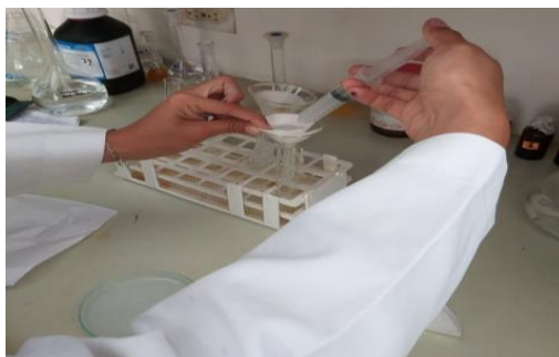
Figura 8 Filtración de las muestras antes de colocar en el espectrofotómetro
