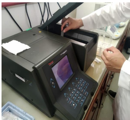
Figura 9. Lectura de absorbancia de las muestras en el espectrofotómetro
