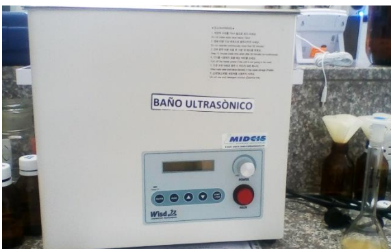
Imagen N.- 9. Extracción de compuestos flavonoides en el equipo de baño ultrasónico.
