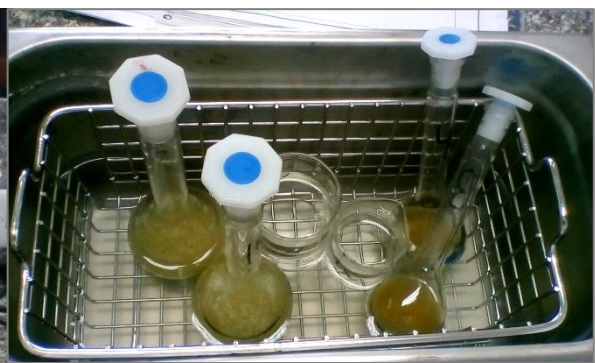
Imagen N.- 9. Extracción de compuestos flavonoides en el equipo de baño ultrasónico.
