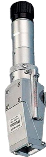
Figura 10: Equipo de refractómetro para medir los °Brix el contenido de azúcares en frutas y soluciones azucaradas.
