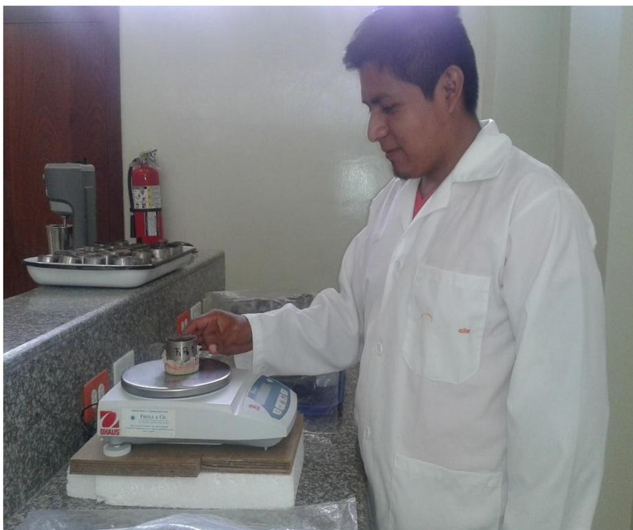
**Foto 7:** Pesado de muestras no alteradas en el laboratorio de suelos UEA.
