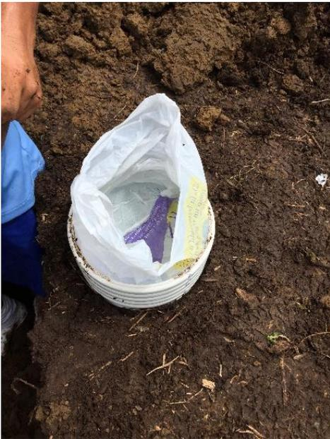
**FOTOGRAFIA 13:** Metodología de impermeabilización del tubo para medición de infiltración
