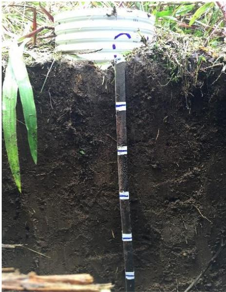
**FOTOGRAFIA 10, 11:** Metodología de excavación de 1m<sup>3</sup> e identificación de los horizontes.
