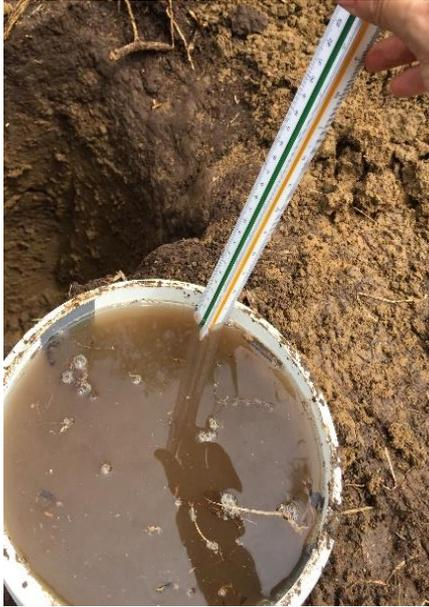
**FOTOGRAFIA 14:** Metodología, medición de infiltración con escalímetro a un minuto.
