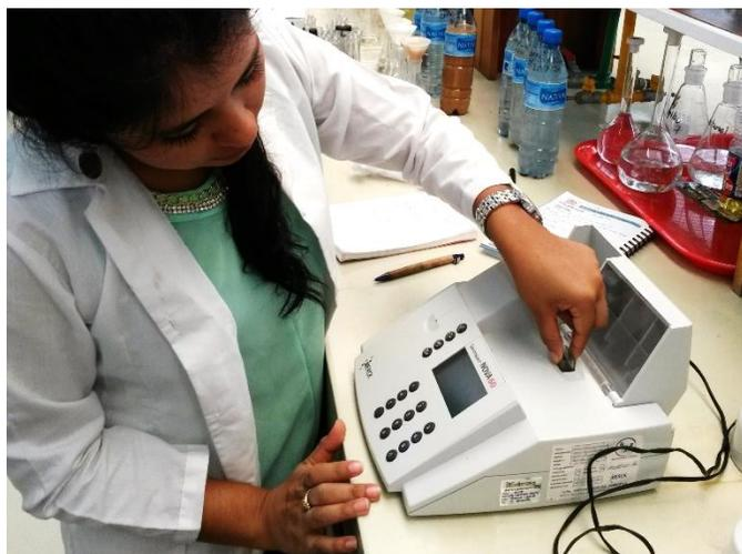
*Gráfico 9.* Determinación de fosfatos en el espectrofotómetro
