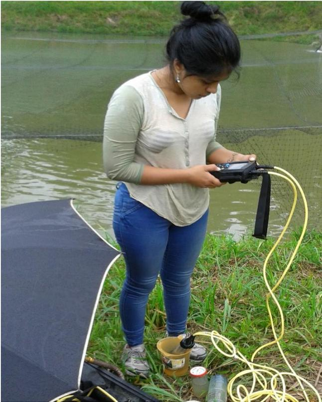
Análisis in situ con medidor multiparamétrico
