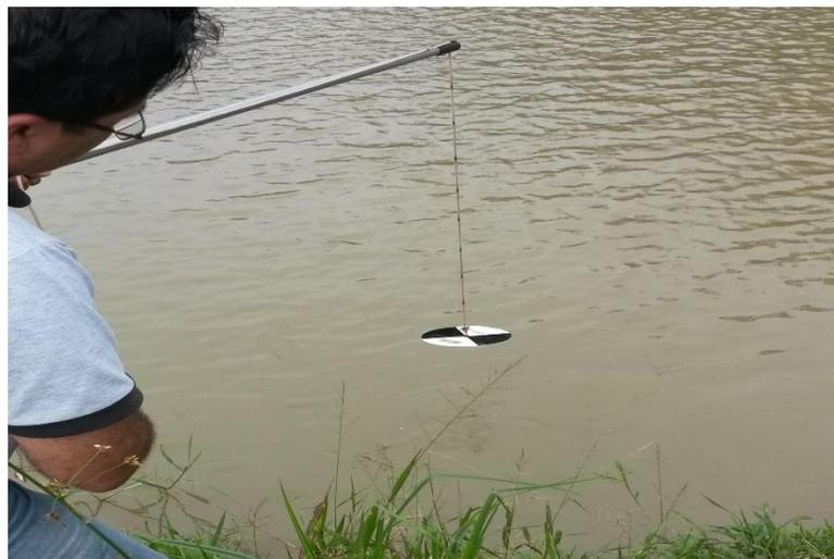
*Gráfico 5. Medición de turbidez con el disco Secchi.*
