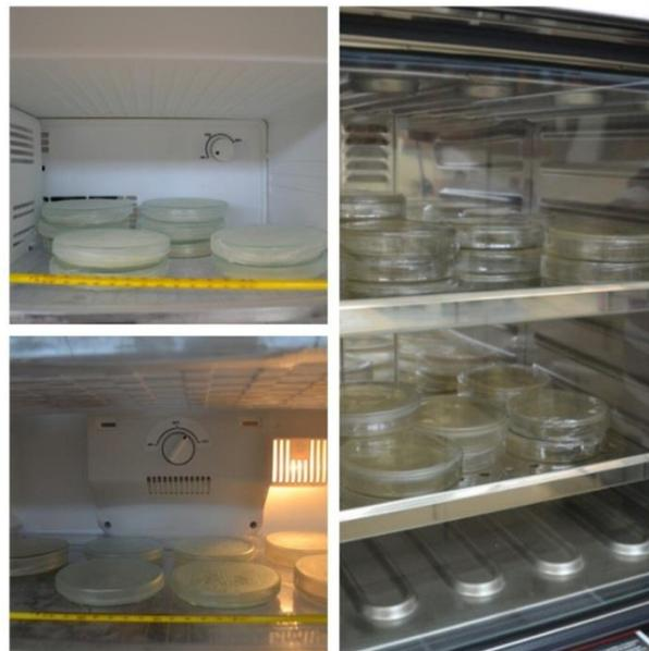
Figura 12 Diferentes temperaturas utilizadas acorde con la posición del refrigerador.
