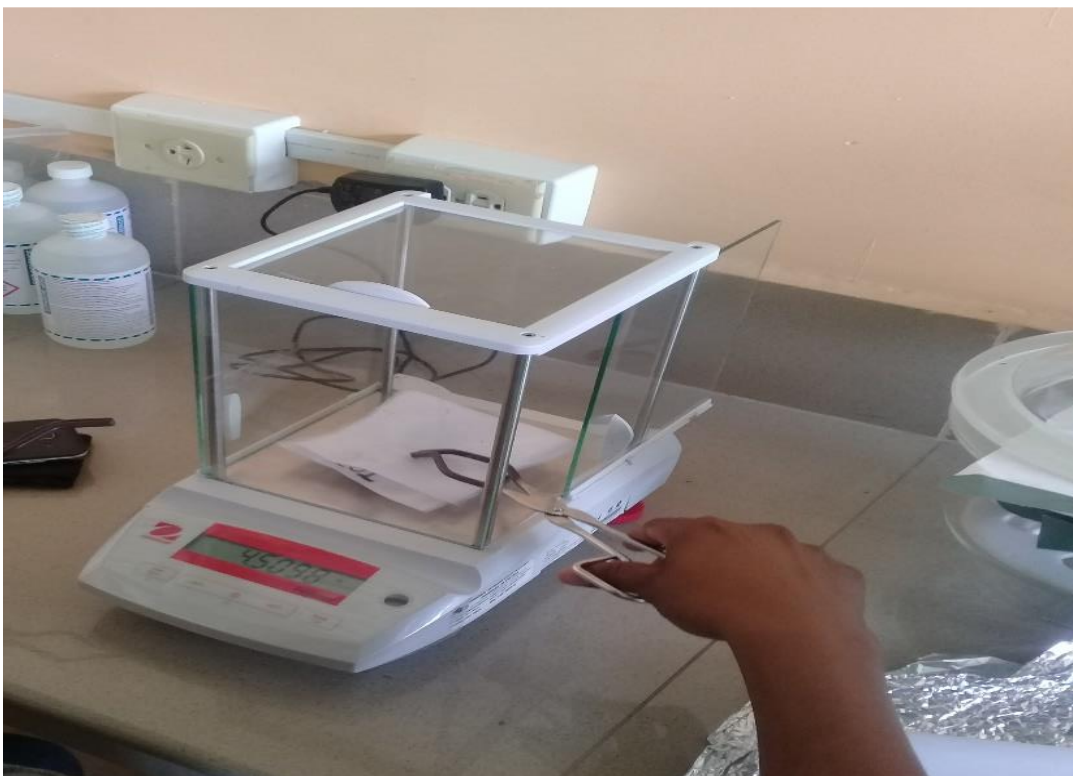
Foto 10. Pesado de cada una de las bolsas de nylon en la balanza de precisión con ayuda de unas pinzas.
