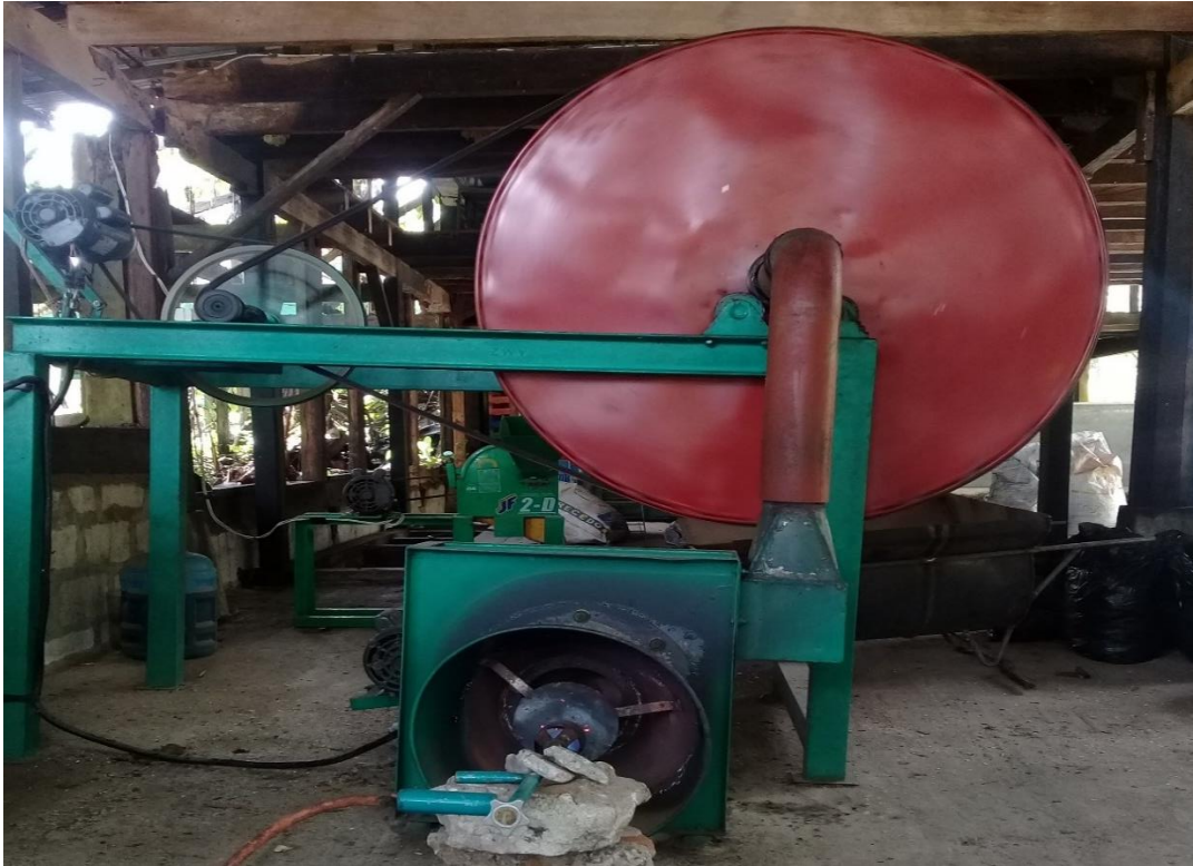
Foto 3. Utilización del tambor para el secado del maní forrajero.
