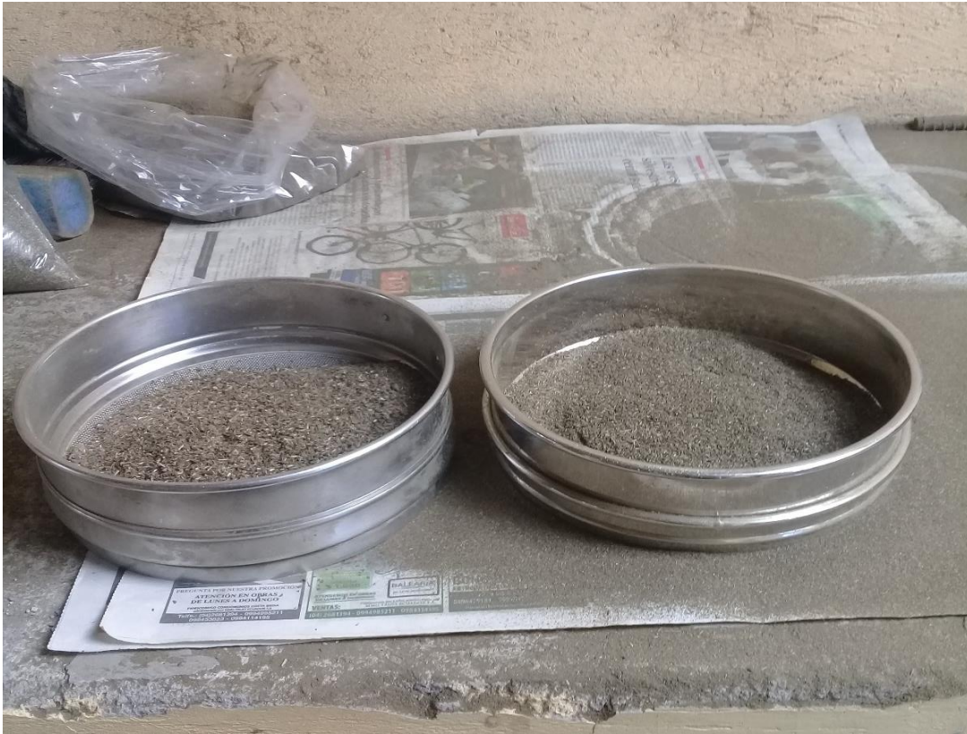
Foto 5. Tamizado de las muestras de maní forrajero en diferentes tamices hasta obtener partículas de 2 mm.
