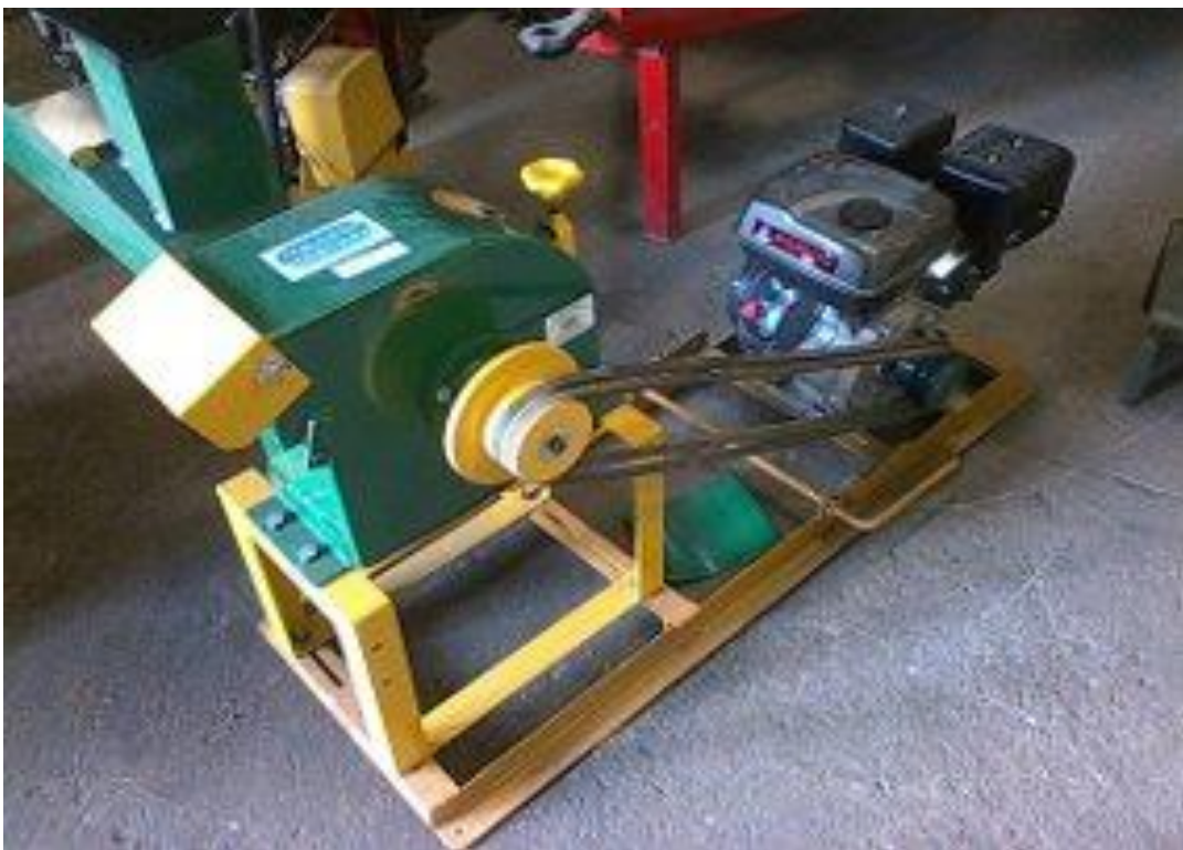
Foto 4. Utilización de la picadora para triturar el maní forrajero una vez secado.
