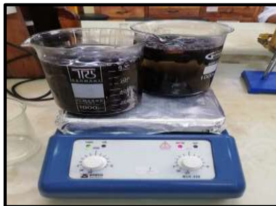
Fotografía 5 Tratamiento térmico: 30 min en ( H_2O ) a 75^{\circ}C .
