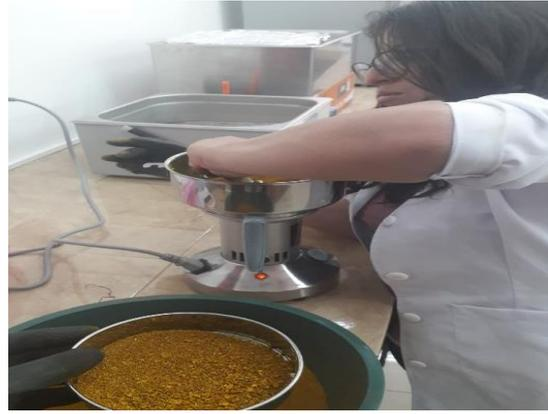
**Foto 3.** Utilización del molino eléctrico para triturar la Cúrcuma una vez secado para posteriormente realizar el tamizado de las muestras de cúrcuma en un tamiz hasta obtener partículas de 2 mm.
