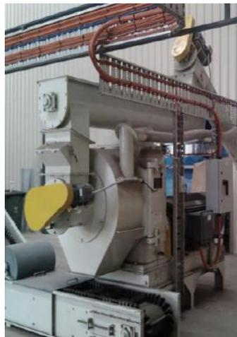
**Figura 11.** Máquina de Producción de Pelles
