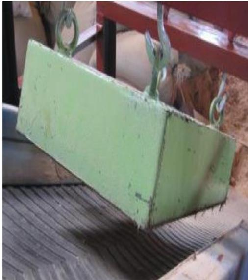
Figura 5. Removedor de impurezas magnético
