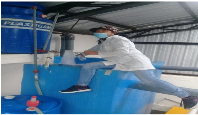
Fotografía 13.- Toma de muestras al ingreso de la PTAP.
