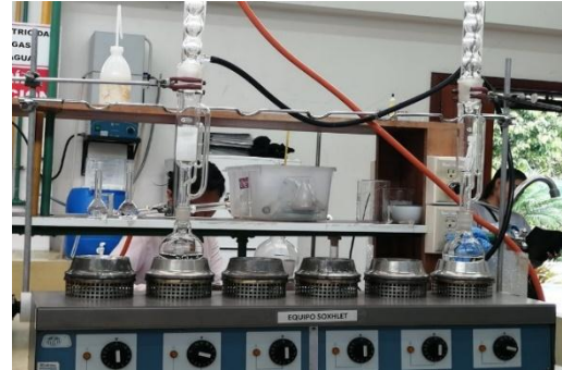
Imagen 6.-Determinacion de grasa por soxhlet
