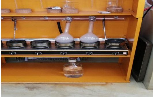
Imagen 5.-Determinacion de proteína por Kjeldahl
