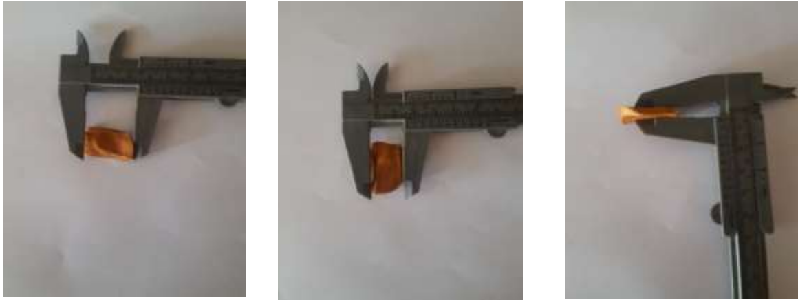
Figura 2. Medición de largo (l), ancho (a) y grosor (g) de las semillas de S. macrophylla
