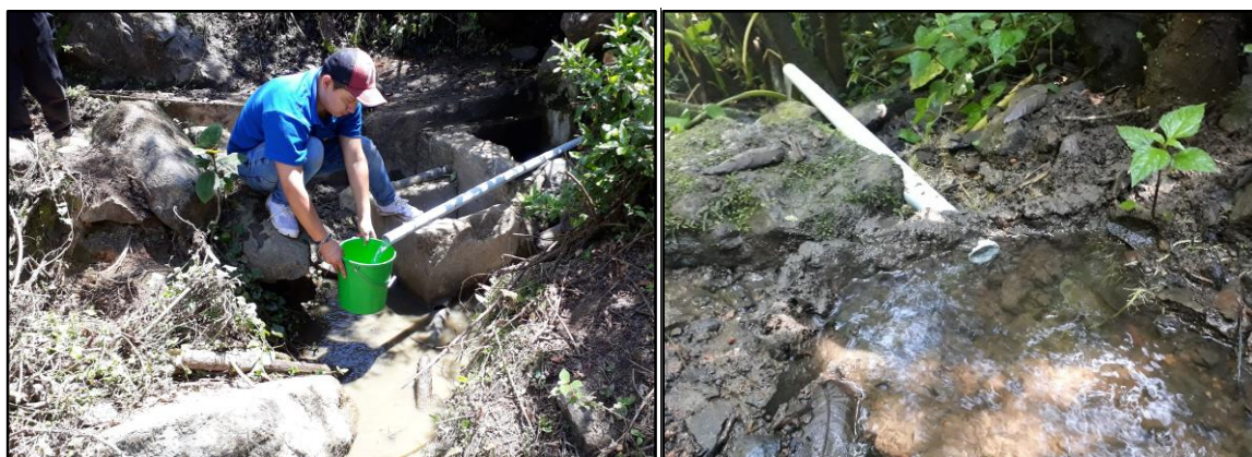
Figura 4. Aforo de caudales con el método volumétrico en las zonas de recarga uno y dos
