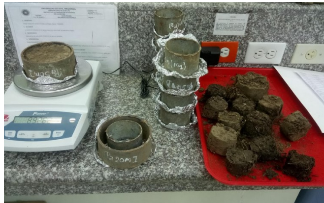
Figura 8. Pesaje de muestras de suelo secas
