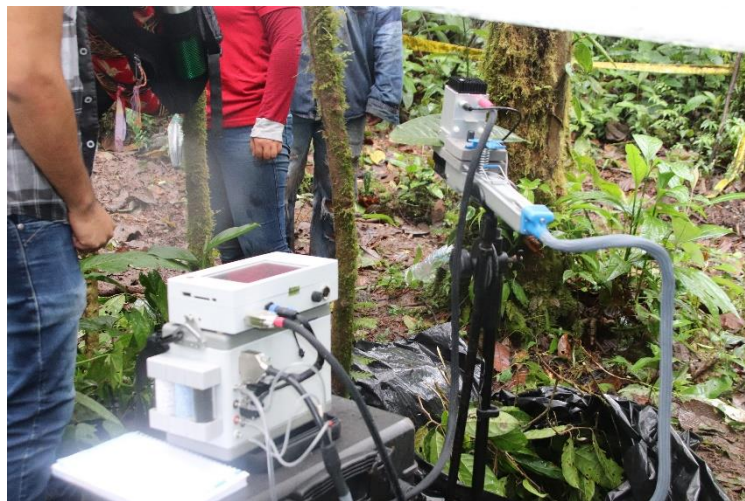
Figura 7. Sistema portátil integrado de medición de fotosíntesis y de fluorescencia de clorofila, (iFL - LCpro-SD, ADC BioScientific Ltd).
