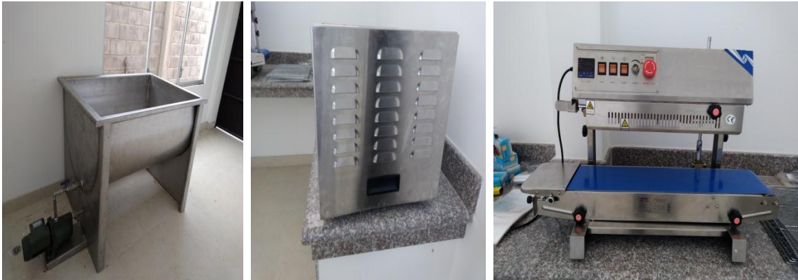
Equipos del área de recepción y laboratorio: Lavadora, Secadora y Selladora.
