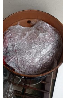
Área de esterilización de residuos agrícolas lignocelulósicos ( Temperatura de 90 a 105 °C)
