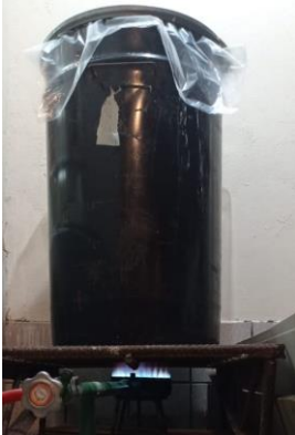
Área de esterilización de residuos agrícolas lignocelulósicos ( Temperatura de 90 a 105 °C)
