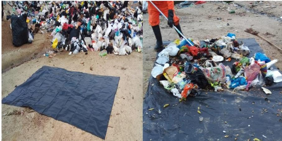
**Figura 11:** *Aislamiento para evitar contaminación de los desechos durante el cuarteo.*
