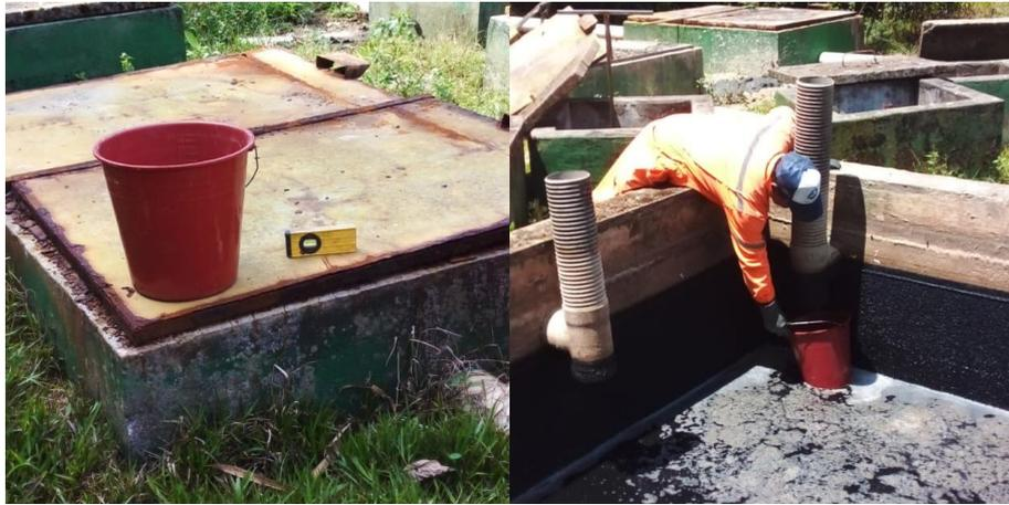
*Figura 16: Aforos para medición de caudales por el método volumétrico.*
