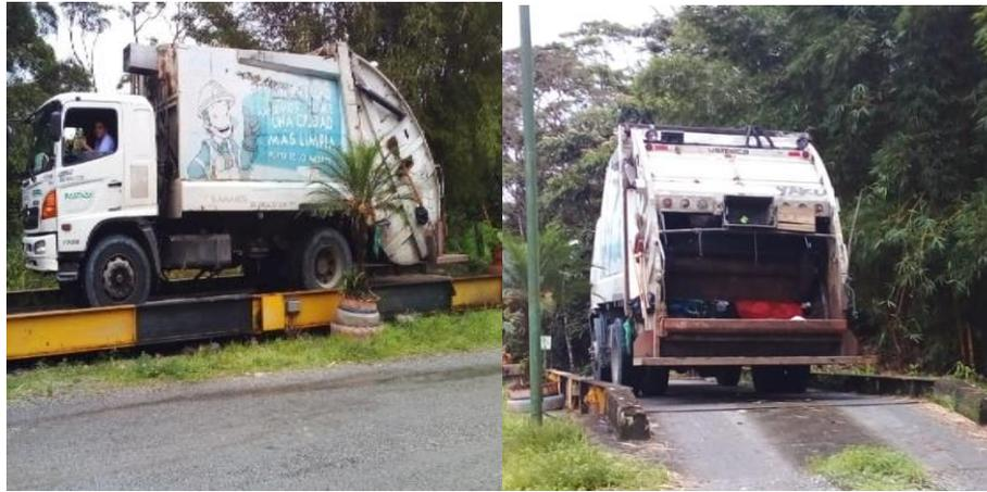
**Figura 6:** *Báscula eléctrica para el pesado y registro de desechos gestionados.*
