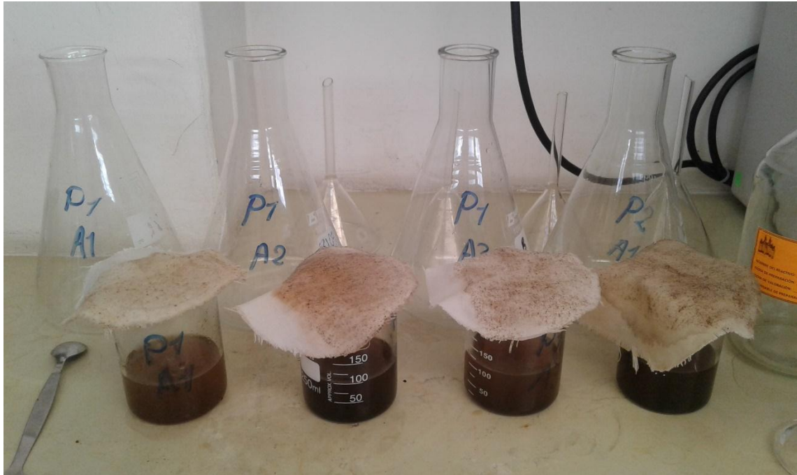
Figura 13. Se adiciona 100 ml de hidróxido de sodio 0.313 N.
