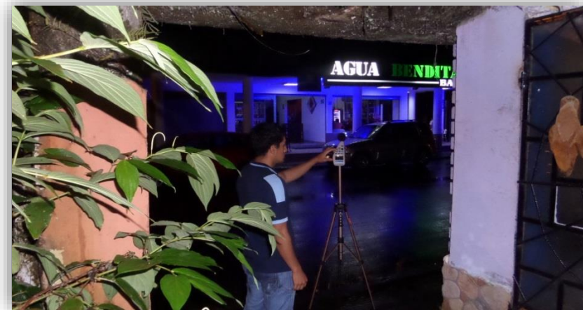
Imagen 11. Medición en punto crítico de afectación “Agua bendita”
