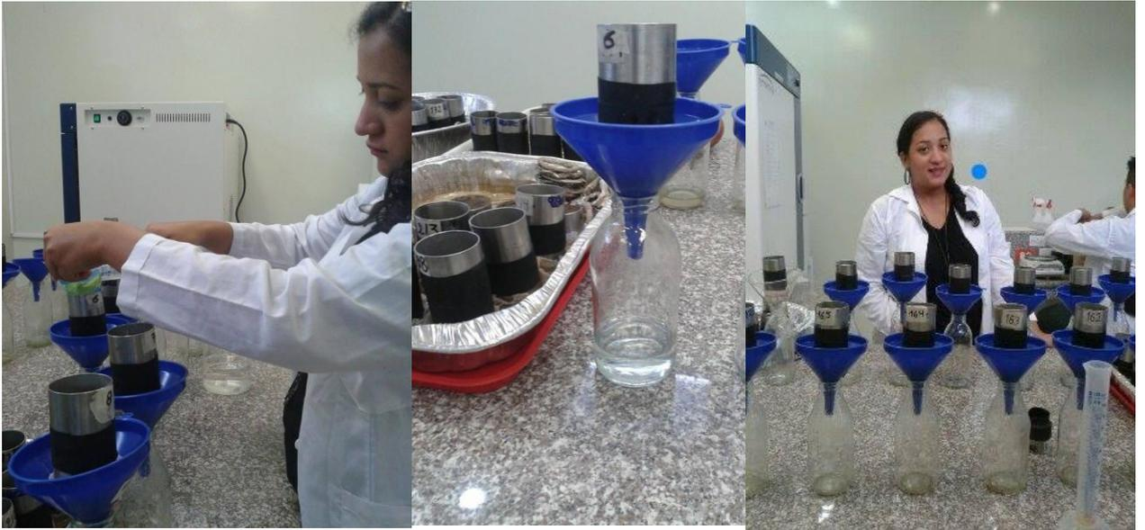
Anexo 5: Determinación de Conductividad Hidráulica
