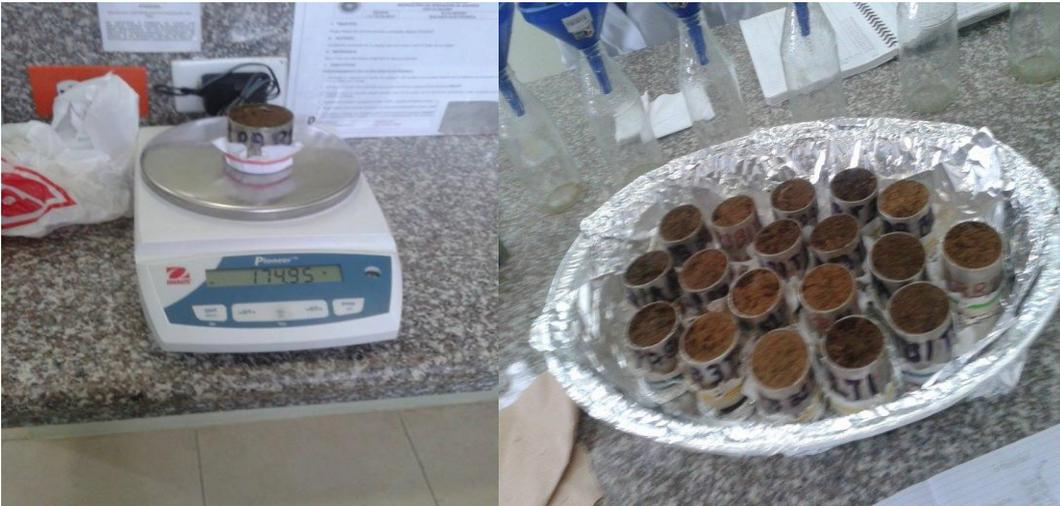
Anexo 4: Pesado y Colocación de las muestras de suelo a Saturar por 24 horas
