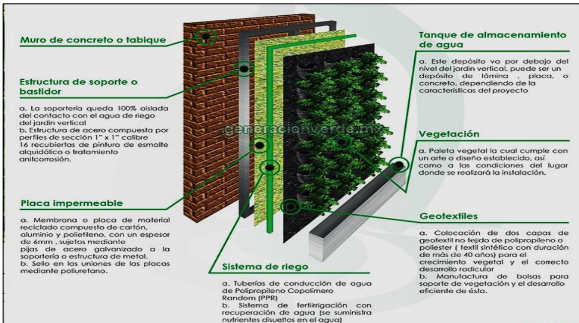
Figura 9. Componentes de la estructura de un jardín vertical Fuente: Fuentes (2017)
