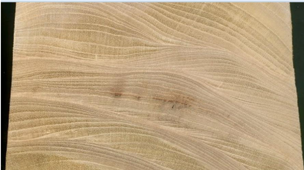
Figura 12. Corte transversal de una muestra de Cedrela montana .
