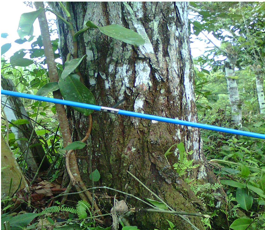
Figura 7. Obtención de un testigo con barreno Pressler.
