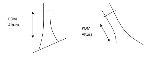
Arboles grandes: estos deben ser medidos entre dos personas se recomienda designar un día para medir solo arboles grandes en una parcela, una escalera es muy útil para alcanzar el POM y si no es alcanzado entonces el diámetro debe ser medido usando método óptico, con una cámara digital o un relaskopio (Phillips & Baker, 2002).
