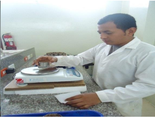
Anexo 8. Determinación de porosidad (parámetro físico) en laboratorio de suelos de la UEA.
