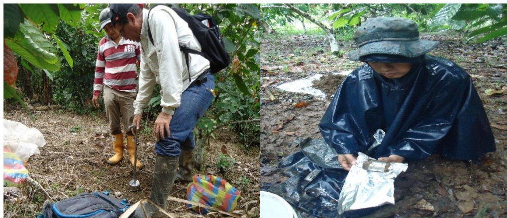
Anexo 4. Obtención de muestras físicas con barreno tipo Uhland en parcela de cacao del cantón Arosemena Tola.
