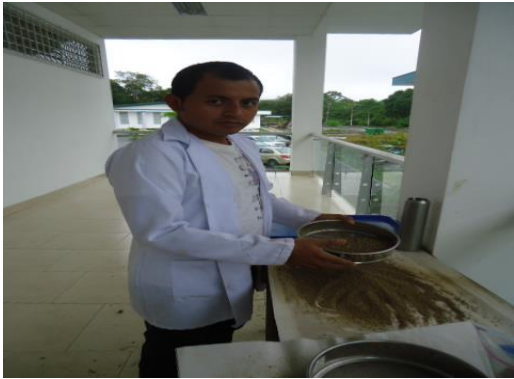
Anexo 7. Tamizado de muestras alteradas, en laboratorio de suelos de la UEA.
