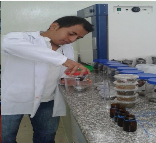
Anexo 10. Determinación de respiración basal (parámetro biológico) en el laboratorio de suelos de la UEA.
