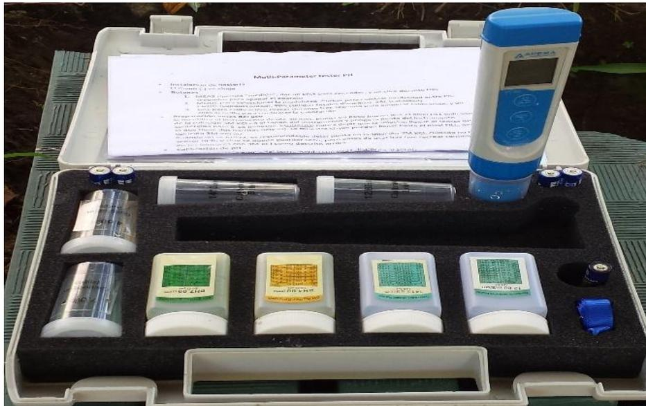
Figura 5. Multi-parámetro portátil PC60 Premium Multi-Parameter Tester (pH/EC/TDS/Salinity/Temp.).
