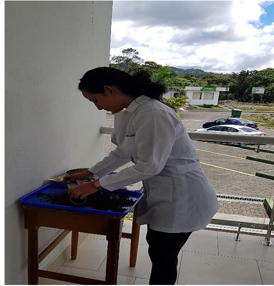
Foto 8. Tamizado respectivo de todas las muestras recolectadas.
