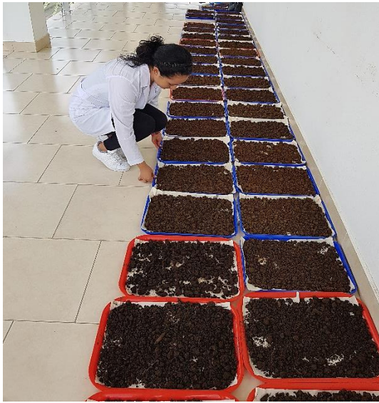
Foto 7. Secado de las muestras para los respectivos análisis de los parámetros físicos.
