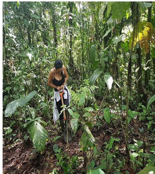
Foto 4. Recolección de muestras a una sola profundidad de (0-30 cm) para los análisis químicos.
