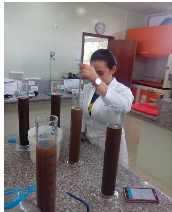
Foto 12. Análisis de la textura por el método de Bouyoucos.
