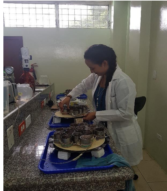
Foto 10. Análisis de la porosidad por el método de la mesa de tensión o saturación.
