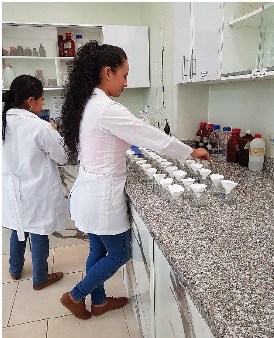
Foto 11. Filtración de las muestras del suelo preparadas para el análisis de acidez y aluminio intercambiable.
