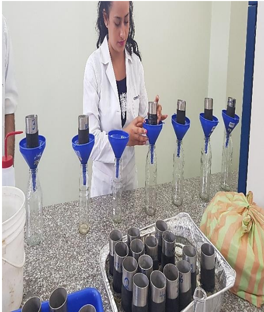
Foto 9. Análisis de la conductividad hidráulica saturada por el método de carga variable.
