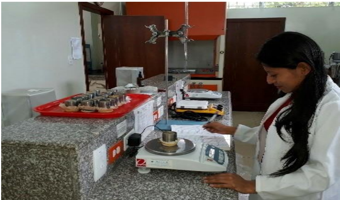
Figura 35. Pesaje de los cilindros para la determinación de densidad aparente del suelo.
