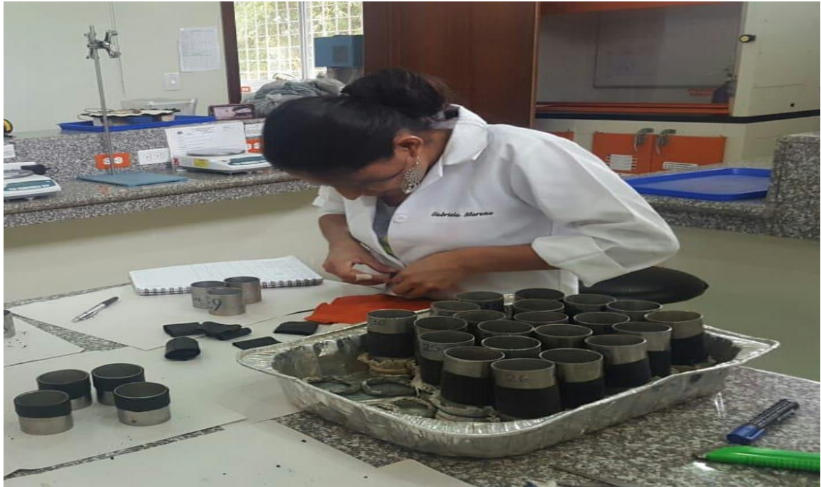
Figura 34. Determinación de conductividad hidráulica.
