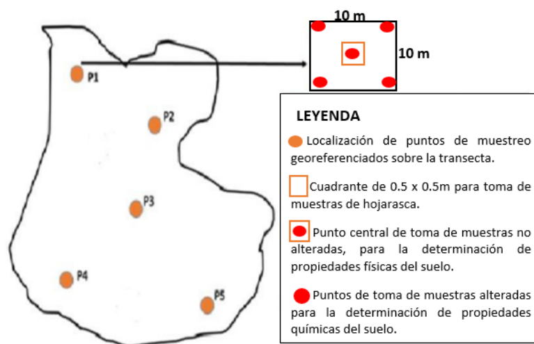
Figura 2. Esquema para la toma de muestras de suelo bajo los distintos tipos de bosque (Tomado de Bravo et al., 2017)
