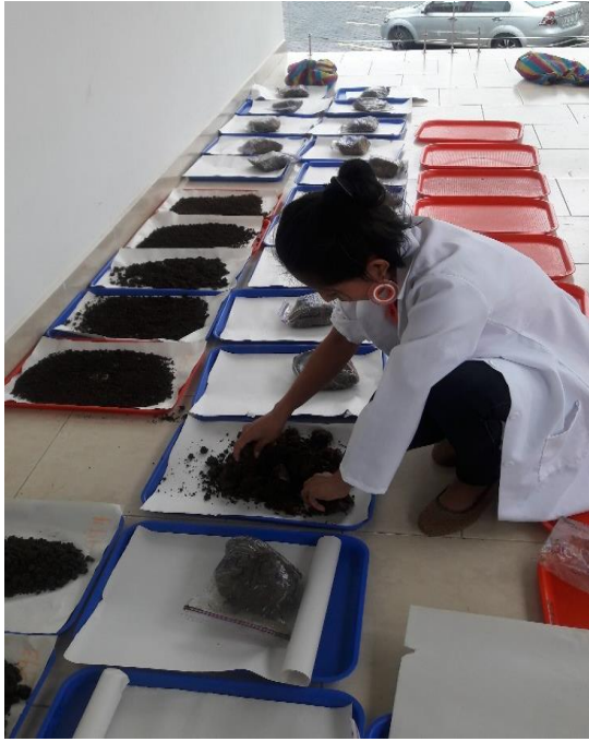
Figura 30. Extendido de muestras de suelo para el proceso de secado.
