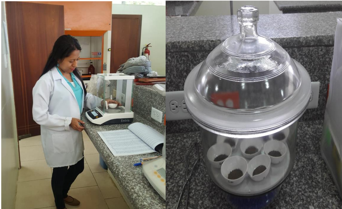
Figura 37. Pesaje de suelo para determinación de carbono mediante el método de calcinación.
