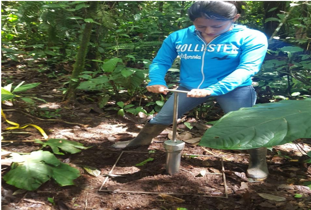
Figura 26. Extracción de muestras no alteradas para determinación de densidad Aparente.
