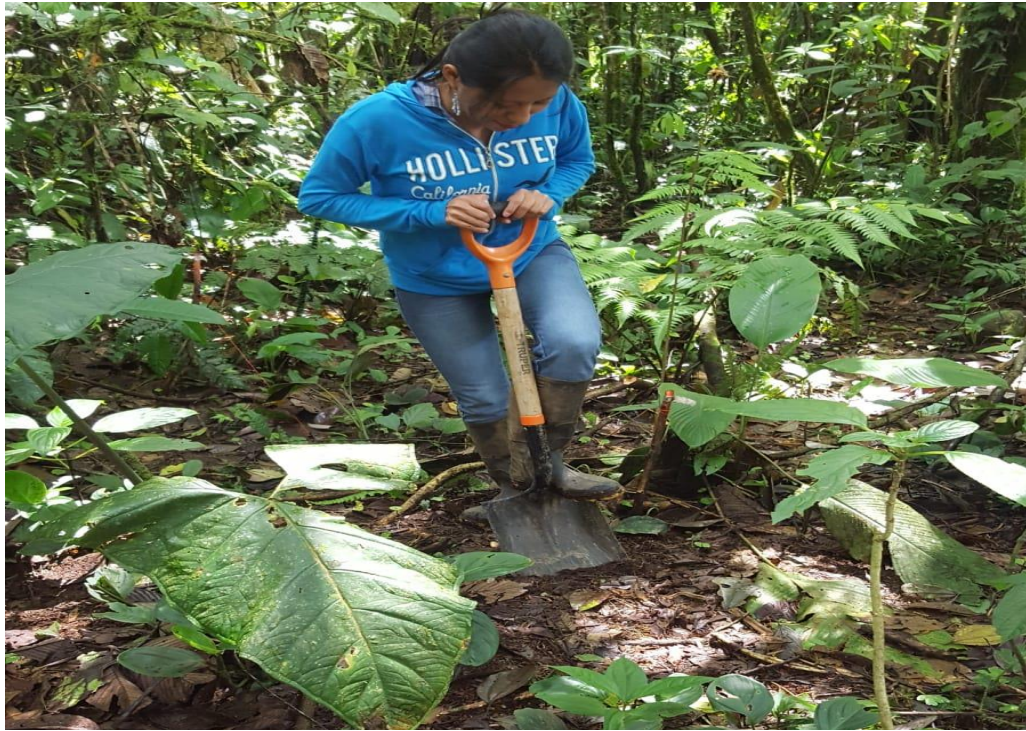
Figura 24. Extracción de muestras compuestas para la determinación de Carbono.
