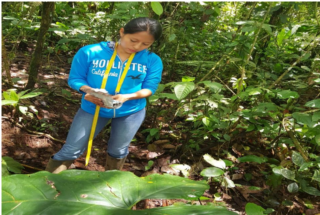
Figura 27. Conservación de las muestras no alteradas sobre papel aluminio para que mantengan sus condiciones de campo.
