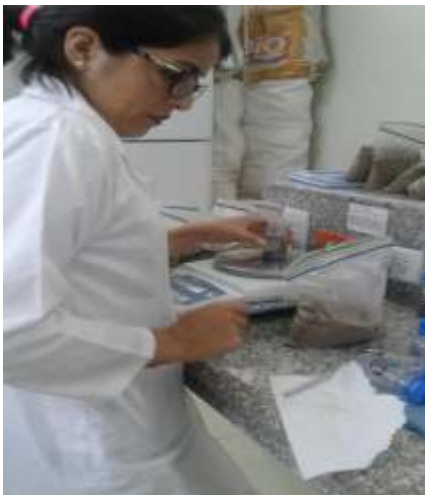
Foto 5. Peso de muestras para analizar AlH y Al^{+3} .
