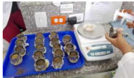
Foto 4. Peso de muestras secas después de 48 horas
