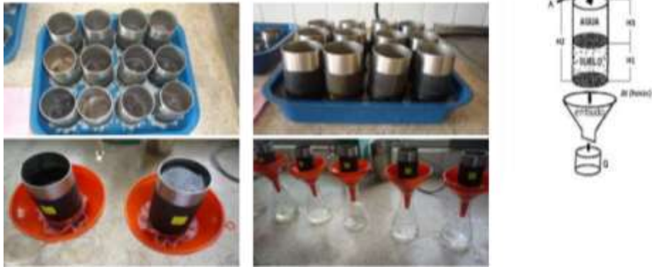
Foto 4. Detalle de determinación de conductividad hidráulica saturada ( K_{sat} ) por el método de carga variable.
