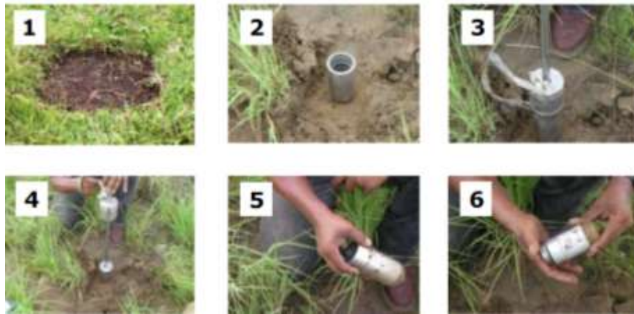
Foto 1. Procedimiento para la toma de muestras no alteradas
