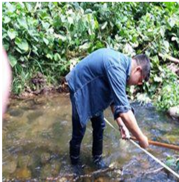
Foto 2: Medición del perfil del afluyente S/N parte alta.
