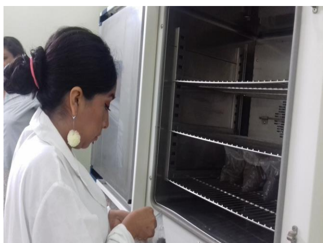
Anexo 11: Secado en la estufa a 105 °C de las muestras para densidad aparente
