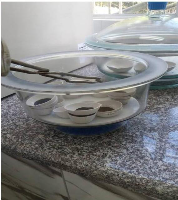
**Fotografía 7.** Crisoles con muestras de suelo calcinado
