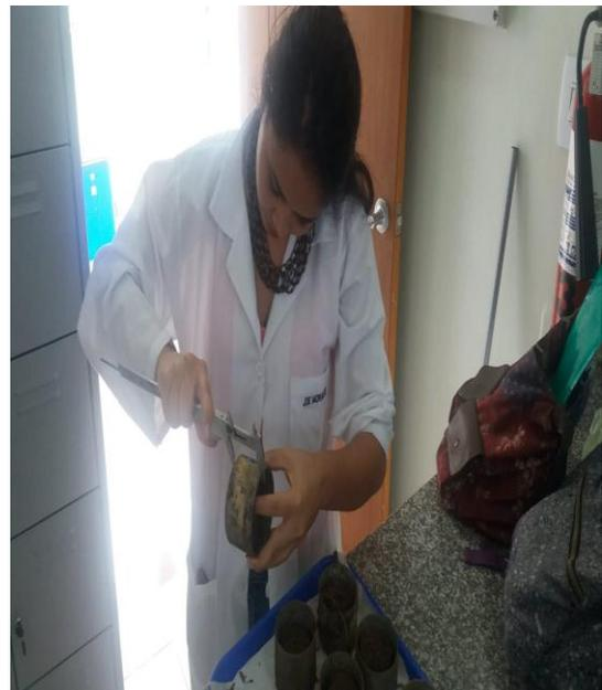
**Fotografía 8.** Medición del diámetro de los cilindros de metal
