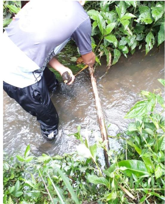
**Fotografía 10.** Medición del ancho del cauce para la estimación de caudal
