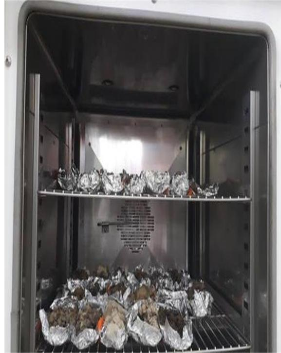
**Fotografía 6.** Incineración de las muestras de suelo
