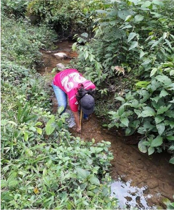
**Fotografía 9.** Medición de cauce para la estimación de caudal
